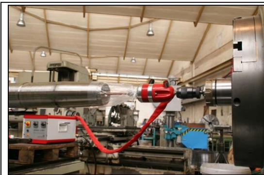
Der stirnseitige Bohrerbruch in einer Welle erfordert nur noch eine kurze Unterbrechung (altes Modell eromobil®).
