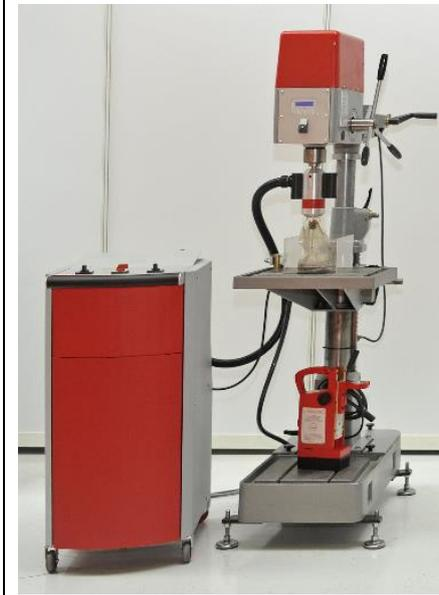
Stationäre Radial-Erodierereinheit mit verfahrbarer x- und z-Achse zur genauen Positionierung der Elektrode. Die um 360° drehbare z-Achse und der schwenkbare Arbeitstisch ermöglichen das Erodieren von großen Werkstücken. Mit Hilfe eines schwenkbaren Erodierkopfes können auch Werkzeugreste aus schrägen Bohrlöchern entfernt werden.
