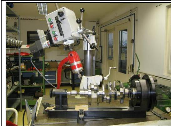
Erodieren einer Nockenwelle auf einer Sondermaschine mit automatischem Vorschub (altes Modell eromobil®).
